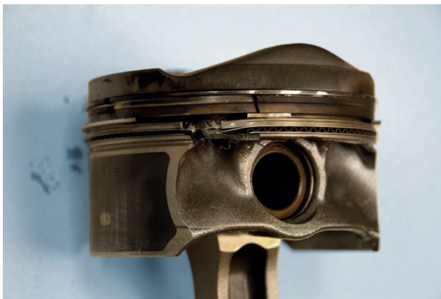
Piston deteriorat de LSPI
